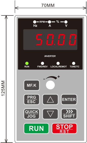
图2-7 LED2钣金结构外引键盘开孔尺寸图
